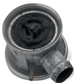
Danno causato dalla condensa dei gas di scarico
